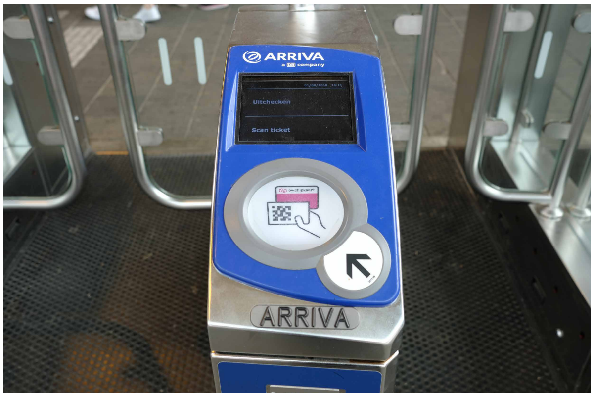
Topcover met barcodelezer en tactiele aanduiding
